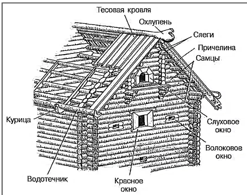
Рис. 8. Схема наименований деталей конструкций русской избы (по В. М. Красовскому)
