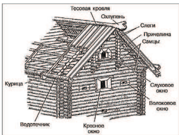
Рис. 23. Схема наименований деталей конструкций русской избы (по В. М. Красовскому)
