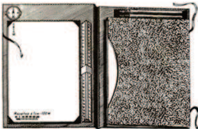
Рис. 2. Планшет для глазомерной съёмки
