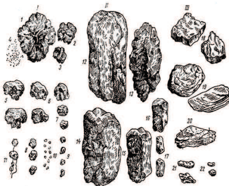
Рис. 41. Главнейшие виды почвенной структуры по С.А. Захарову. I тип: 1 – крупнокомковатая; 2 – среднекомковатая; 3 – мелкокомковатая; 4 – пылеватая; 5 – крупноореховатая; 6 – ореховатая; 7 – мелкоореховатая; 8 – крупнозернистая; 9 – зернистая; 10 – порошистая; 11 – «бусы» из зерен почвы. II тип: 12 – столбчатая; 13 – столбовидная; 14 – крупнопризматическая; 15 – призматическая; 16 – мелкопризматическая; 17 – тонкопризматическая. III тип: 18 – сланцеватая; 19 – пластинчатая; 20 – листоватая; 21 – грубочешуйчатая; 22 – мелкочешуйчатая.
