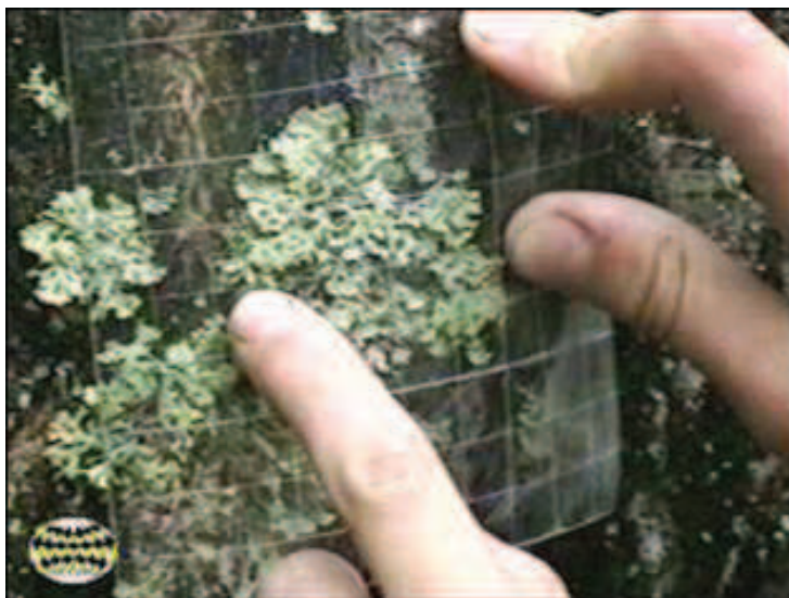
Рис. 49. Рамка (сеточка) для определения проективного покрытия эпифитных лишайников (Пчёлкин А.В. Использование лишайников и водорослей в экологическом мониторинге и биоиндикационных исследованиях // Экосистема. Режим доступа: http://www.ecosystema.ru/07referats/pchelkin/monitoring.htm )
